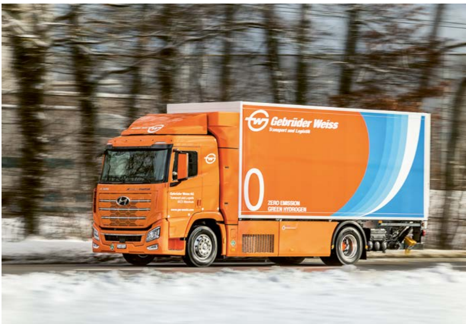
Der Wasserstoff-Lkw ist für den Transport von rund 25 Tonnen Ware ausgelegt. Die Reichweite beträgt etwa 600 Kilometer. (Quelle: Gebrüder Weiss/Stefan Peter)
